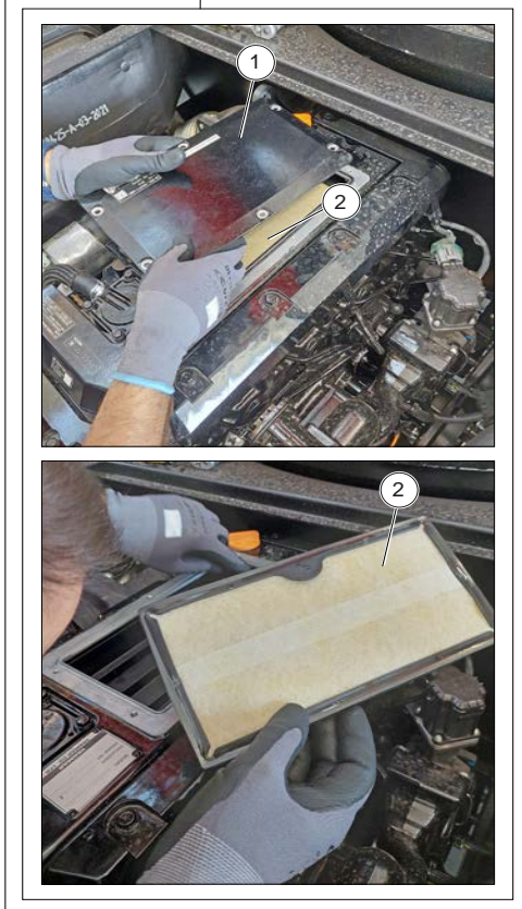
Afbeelding 209: Het carterfilter van de motorontluchter vervangen
